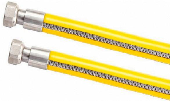
Flessibile per Cucina in acciaio inox Trecciato con filo in ACCIAIO, raccordi acciaio, **calotte sinistre** Adatto per collegamento bombole, centraline ed impianti G.P.L.
